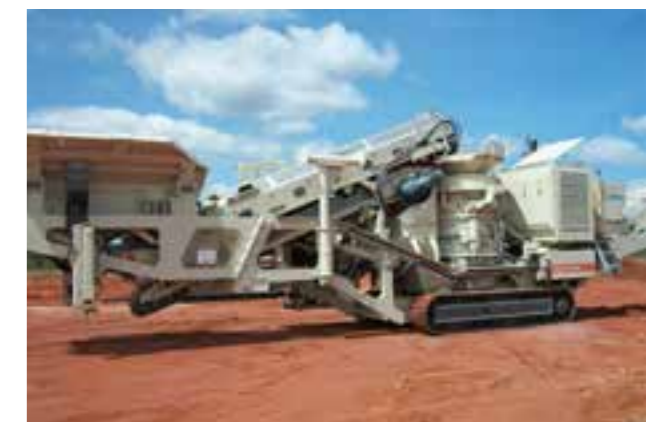
Der Lokotrack LT300HP ist mit Bandaufgeber ausgerüstet oder alternativ mit einem Vibrationsaufgeber mit Rost.
